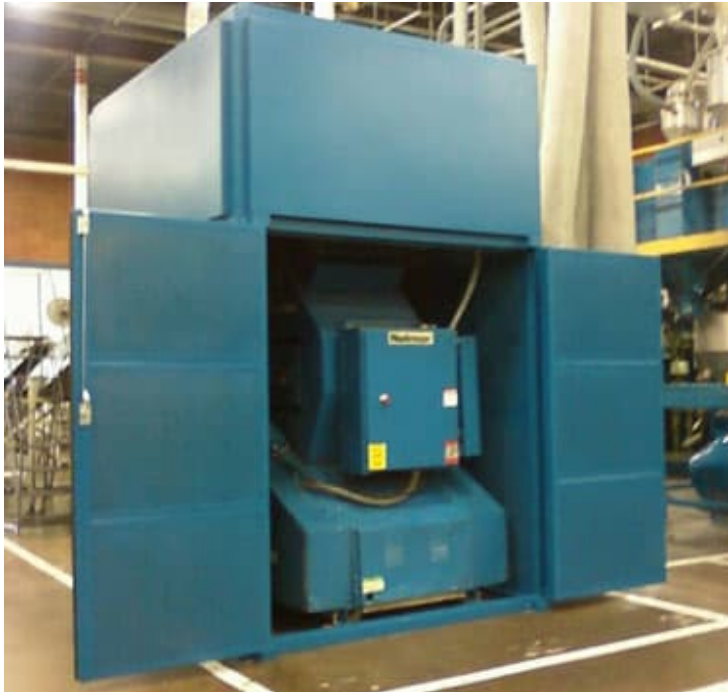
Slika 38. Karakterističan prikaz akustičkog oklapanja izvora buke ( poveznica )
