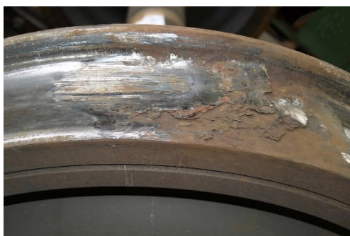
Slika 33. Karakterističan prikaz lokalnih neravnina na kotaču
