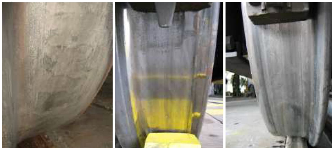
Slika 34. Prikaz površine kotača nakon djelovanja kočnica opremljenih različitim tipom papuča (redom slijeva: blok od lijevanog željeza, LL papuča IB116, LL papuča C952-1)
