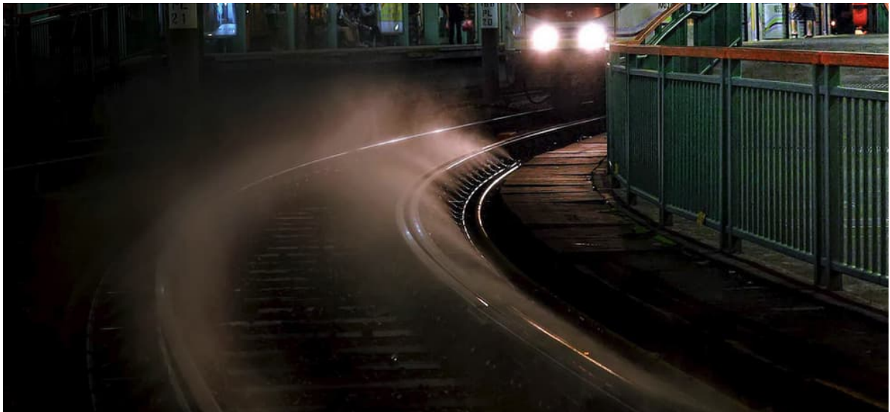
Slika 27. Prikaz ugrađenog sustava za zalijevanje vodom dodirnih površina
